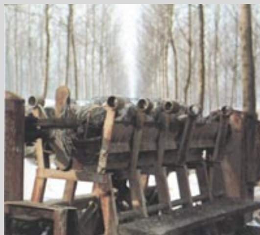
Stroj za proizvodnju vrećastih gabiona
