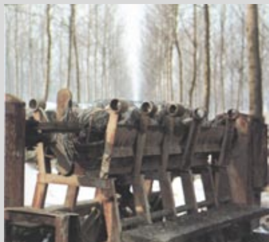
Stroj za proizvodnju vrećastih gabiona
